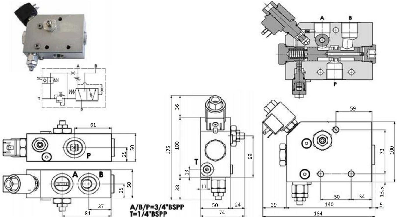
**Materiali:** Corpo in acciaio zincato. I componenti interni sono in acciaio trattato termicamente.
