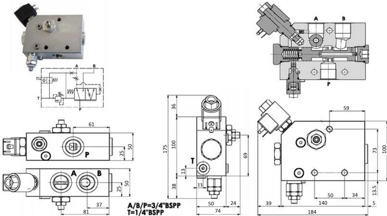
**Materiales:** Cuerpo en acero zincado. Partes internas en acero endurecido.**Caudal máx.:** 200 l/min con 140 l/min en "A"**Presión max. en línea prioritaria:** limitada por válvula limitadora de presión, muelle 20/35**Escape max.:** 3 L/min**Contrapresión max. en T:** 1.5 bar
