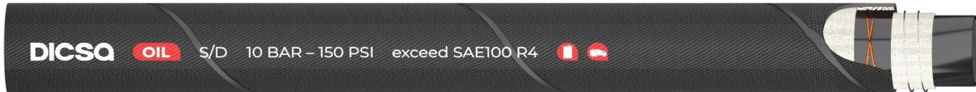
**Descrizione e applicazioni:** Tubo fabbricato a mandrino per aspirazione/impulsione di carburanti, olii e fluiti de origine petrolifero con contenuto massimo de aromatici del 50%. Adeguato anche per servizi gravosi con aria compressa ed acqua en miniera ed industria in generale.
