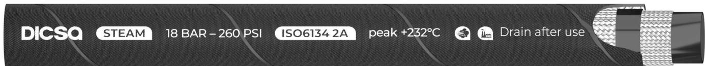
**Descrizione e applicazioni:** Tubo fabbricato a mandrino per impulsione di vapore saturo 18 Bar 210°C e punte di vapore surriscaldato fino 232°C. Tubo fabbricato secondo la norma ISO6134 2A
