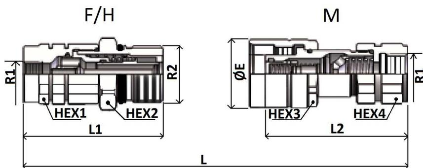
**Matériel:** Acier**Joints:** NBR**Température de service:** -25°C / +100°C**Pression de service:** 300-450 bar**Connexion sous pression:** Possible (côté male ou femelle)**Pression restante max:** 300 bar
