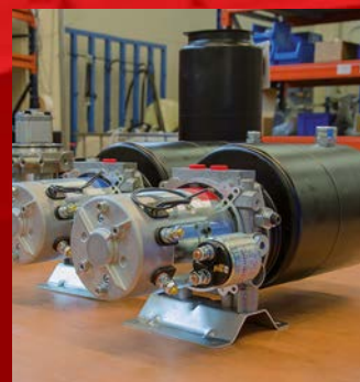
MONTAJE DE MINICENTRAL POWERPACK ASSEMBLY
